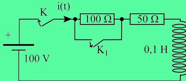
Pour  $0 \leq t \leq 4 \text{ ms}$  : Seul la résistance de  $50 \Omega$  est en circuit. On a donc une évolution du courant du type :
