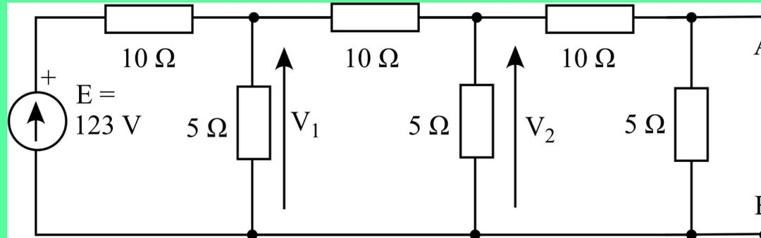
La résistance équivalente de Thévenin se calcule directement par : (E étant remplacée par un CC)
