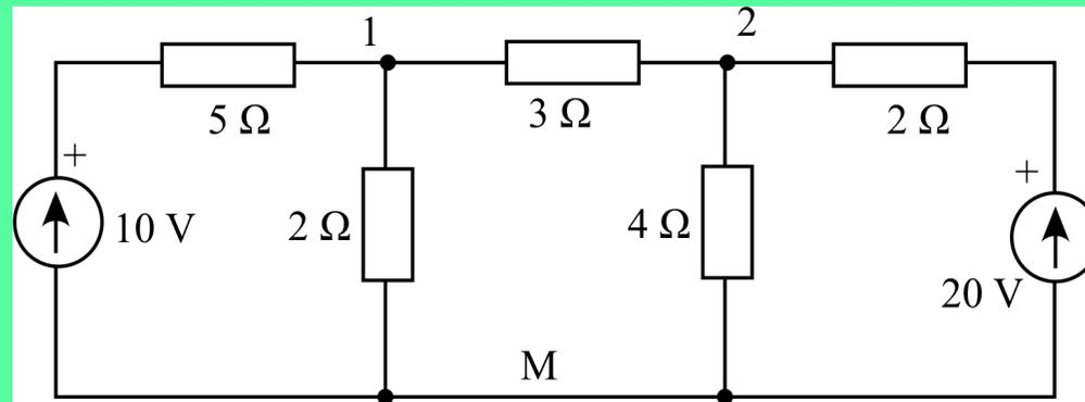
Les tensions de nœuds sont  $V_{1M}$  et  $V_{2M}$ .
