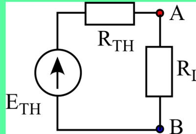
Le transfert maximal de puissance se fera pour  $R_{TH} = R_L = 3,658 \Omega$
