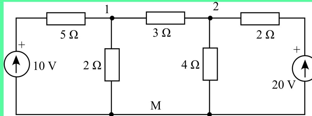
$$V_1 = 5,45 \text{ V}$$
