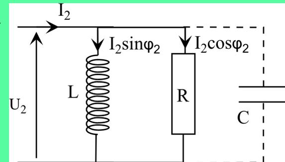
$$\Delta U = 0 \Rightarrow \tan \varphi_{2l} = -\frac{R_S}{X_S} \text{ et par ailleurs } \tan \varphi_{2l} = R \left( \frac{1}{L\omega} - C\omega \right) \\ \Rightarrow C = \frac{1}{\omega} \left( \frac{1}{L\omega} - \frac{\tan \varphi_{2l}}{R} \right)$$
