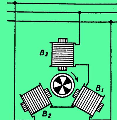
Les machines asynchrones présentent une vitesse nominale légèrement inférieure au synchronisme. Par exemple, un moteur de vitesse nominale 1455 tr/mn est prévu pour une alimentation à 50 Hz et possède 4 pôles.
