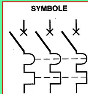
**Un déclencheur thermique**
